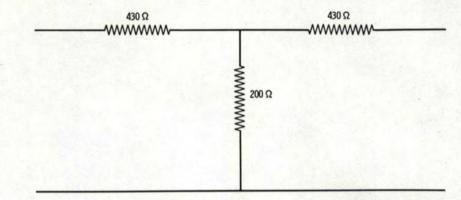
Figure 2-2. 600-ohm, 16 dB Attenuation Network
