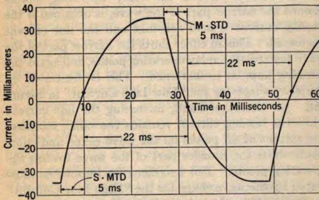
FIG. 184. SIGNAL WAVE SHAPES IN POLAR TELEGRAPH CIRCUITS
