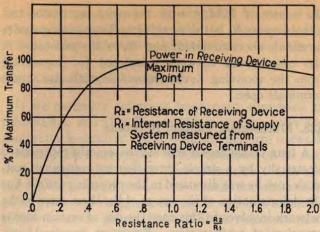
FIG. 254. POWER TRANSFER AS A FUNCTION OF RESISTANCE RATIO
