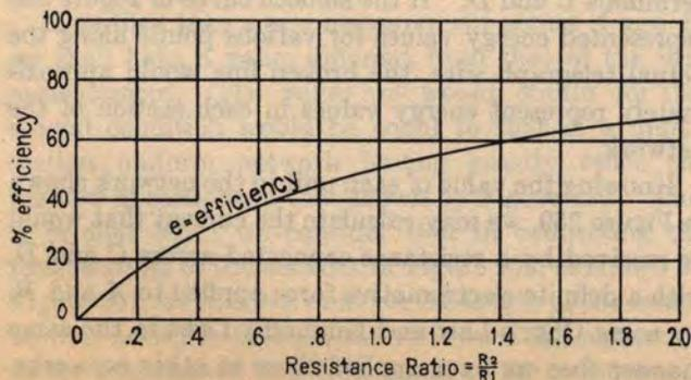
FIG. 255. EFFICIENCY AS A FUNCTION OF RESISTANCE RATIO
