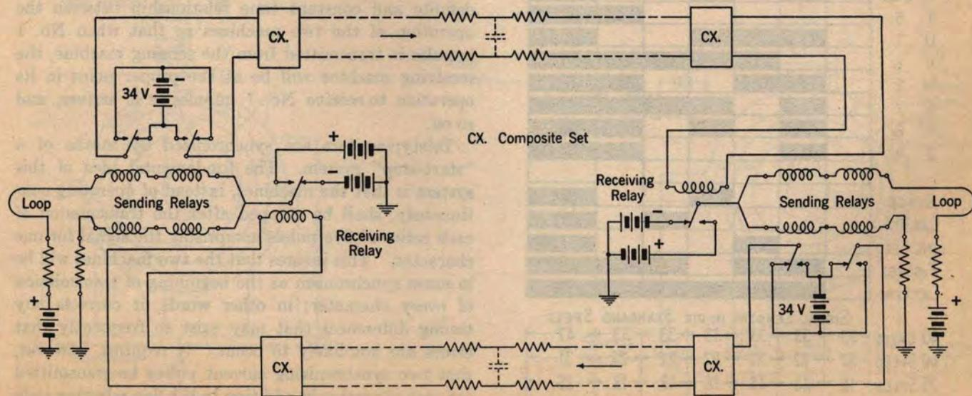
FIG. 166. 4-WIRE METALLIC TELEGRAPH CIRCUIT
